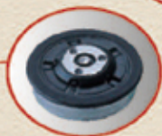
DVD用小型ブラシレスDCモータ Small brushless DC motor for DVD drive
